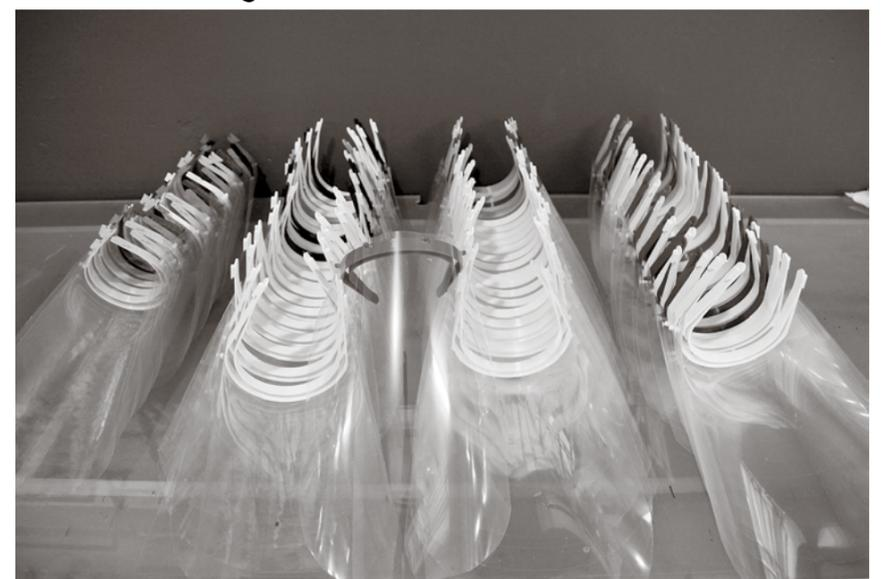
o modelo padrão internacional. Ela é formada por três peças: a placa de acetato, transparente, que é a viseira; uma "tira" com pontos que serve de sustentação (a única confeccionada na impressora 3D efetivamente); e um elástico que ajuda a fixar o equipamento no profissional.
